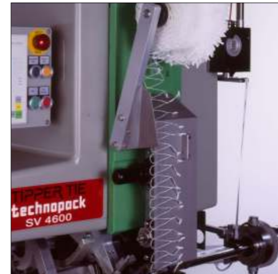
Schlaufeneinleger mit Verdrängerschere Loop inserter with voiding system Pose de bride avec ciseaux d'embossage Colocador de lazo con tijera de empuje
