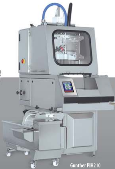
Gunther PIH210 Inyectora de salmuera con un cabezal de 210 agujas.
