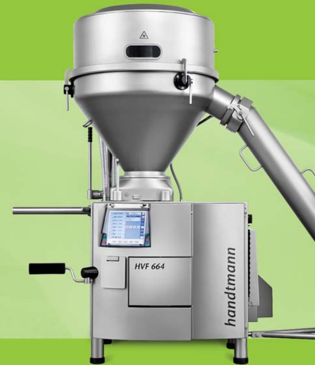
Handtmann HVF664 Embutidora de alto vacío para Jabonería y emulsiones capacidad 14.000 Kg/hs.
