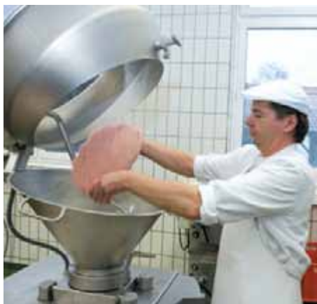
Embutición sencilla mediante división de tolva
