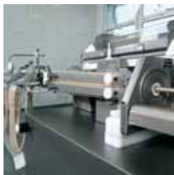
Longitudes, calibres y pesos de salchicha iguales con la unidad de longitudes iguales y el paso a la unidad de colgado
